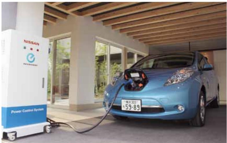
日産「リーフ」は車載されている電池から住宅に電力を供給するシステムを搭載している。横浜市では、住宅メーカーとともにスマートメーターを備える住宅に「リーフ」をつないだ場合のテストを行っている。
