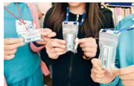
首から提げているガラスバッチ(積算線量計)
